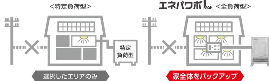
全負荷型の停電時にご使用可能な電力は、蓄電システムの放電電力(最大3kW)と太陽光発電で発電した電力(最大6kW)とエネファームで発電した電力(最大700W)になり、9.7kW以内となります。太陽光発電の接続可能容量は、6kW以内とさせていただきます。6kWを超える太陽光発電の接続はできません。※詳しくは各販売店にお問い合わせください。
